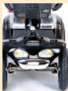
Conjunto de luces e indicadores
